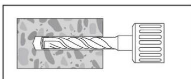
Perforar el orificio con el diámetro y la profundidad correctos utilizando un talador percutor. Compruebe la perpendicularidad del orificio durante la operación de perforación.
