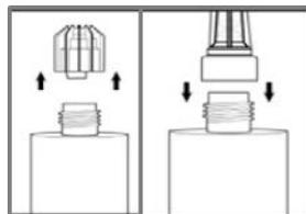
Desenrosque el tapón del cartucho y fije firmemente la boquilla mezcladora.
