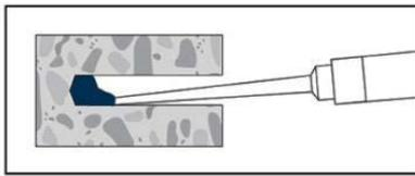
Llenar el agujero uniformemente desde el fondo del taladro, para evitar el atrapamiento de aire. Quite el mezclador poco a poco durante el presionado. Rellenado del agujero con una cantidad de mortero de inyección correspondiente a 2/3 de la profundidad del taladro.
