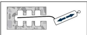
Limpie el orificio del polvo de perforación, fragmentos de núcleo, aceite, agua, grasa y otros contaminantes antes de la inyección de mortero (con soplador manual y cepillo manual estándar).
