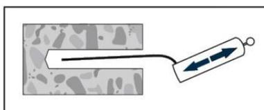
Limpie el agujero del polvo de la perforación, de fragmentos, de aceite, agua, grasa y de otros contaminantes antes de la inyección del mortero con un cepillo manual, soplador y o un cepillo de cerdas de acero.
