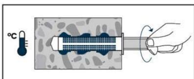
Inserte inmediatamente la varilla roscada, lentamente y con un ligero movimiento de torsión, retirando el exceso de mortero de inyección alrededor de la varilla roscada. Observe el tiempo de procesamiento.
