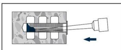
Llenar el tamiz uniformemente comenzando desde el fondo; Retirar lentamente el mezclador poco a poco durante: extraer la cánula unos 10 mm para cada operación de prensado.
