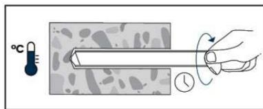
Inserte inmediatamente la varilla roscada lentamente y con un ligero movimiento de torsión, retirando el exceso de mortero de inyección alrededor de la varilla roscada.
