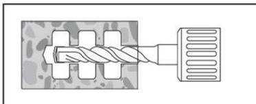
Taladre el agujero con el diámetro y la profundidad correctos usando el taladro apropiado. Compruebe la perpendicularidad del orificio durante la operación de perforación.
