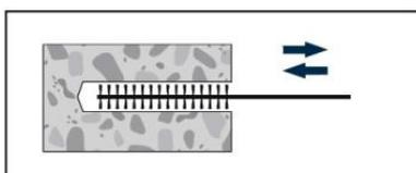
El orificio debe limpiarse por lo menos con 4 operaciones de cepillado seguido por al menos 4 operaciones de soplado.
